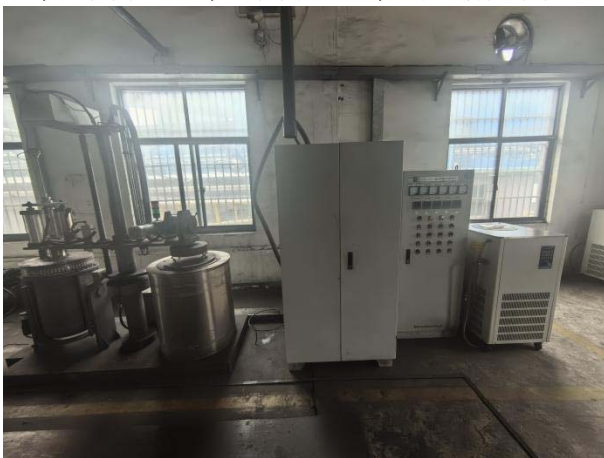
图1.1 40kg环保荷重试验小焦炉
