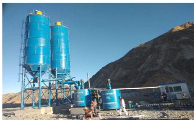
图1 尾砂胶结充填采矿方法
