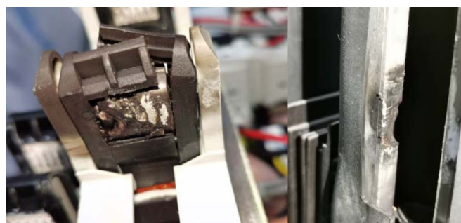
图3 开关B相动触头(左)及垂直母排(右)
